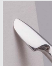
Den vingade elevatortippen placeras platt mot slipstenen.
