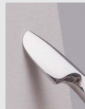
La pointe de l'élévateur à ailes est placée à plat contre la pierre à aiguiser.
