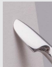
Die Spitze des Winged Elevators wird flach auf den Schleifstein gelegt.
